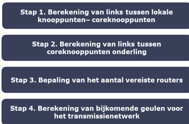
Figuur 7.15: stappen voor de dimensionering van het transmissienetwerk [Bron: Axon Consulting]
